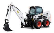
6) Траншеекопатель - Этот универсальный инструмент можно использовать для самых разных работ: от легкого до высокопроизводительного рытья траншей. Глубина выемки грунта варьируется от 60 см до 1,5 м. Функция бокового смещения позволяет приблизиться вплотную к стене или забору.
