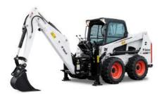
6) Траншеекопатель - Этот универсальный инструмент можно использовать для самых разных работ: от легкого до высокопроизводительного рытья траншей. Глубина выемки грунта варьируется от 60 см до 1,5 м. Функция бокового смещения позволяет приблизиться вплотную к стене или забору.
